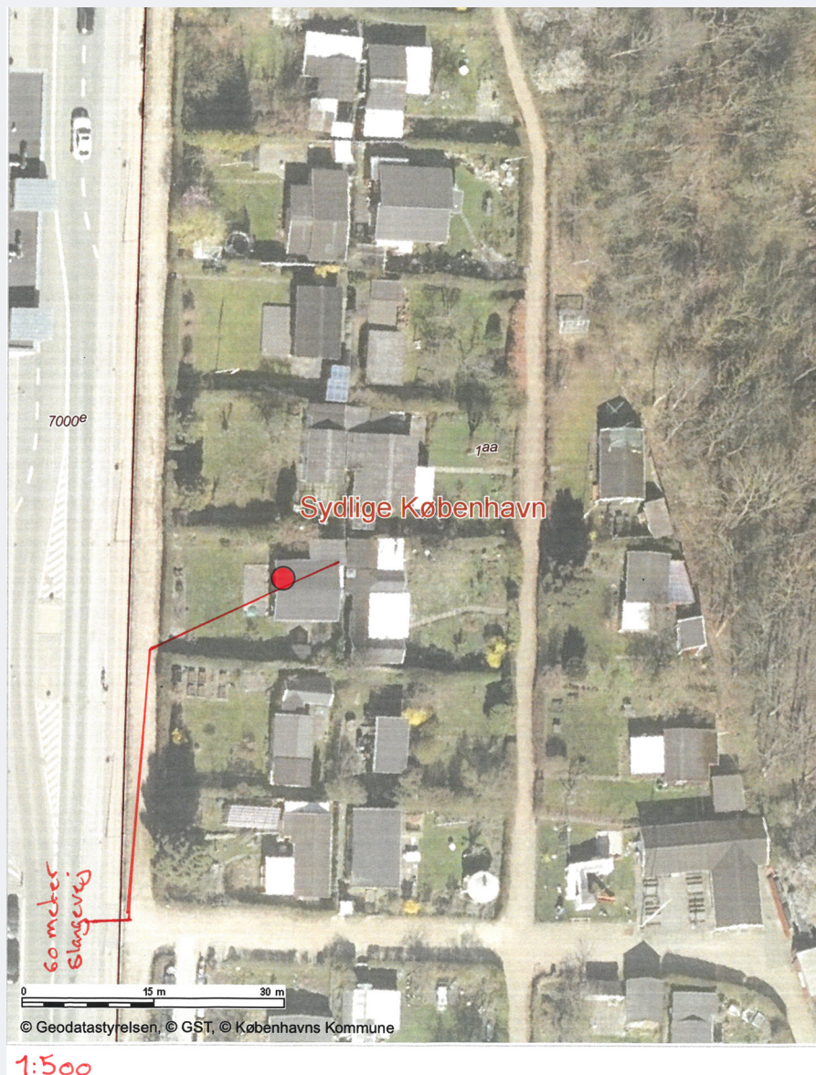
Figur 3. Situationsplan med angivelse af, at brandbil kan holde på gade eller godkendt brandvej max. 80 m fra dit hus "slangevej".
